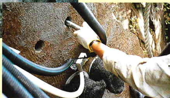
AEセンサ設置状況
