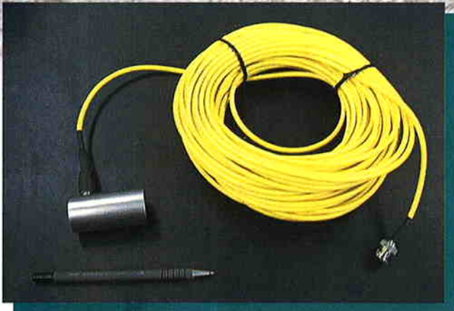
開発した斜面動態計測用AEセンサ
