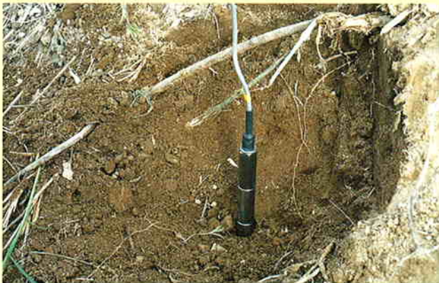
AEセンサ設置状況
